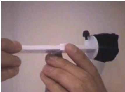
Medida del espesor de la cámara a través de una cata
