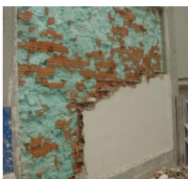
Comprobación en laboratorio del completo llenado de la cámara
